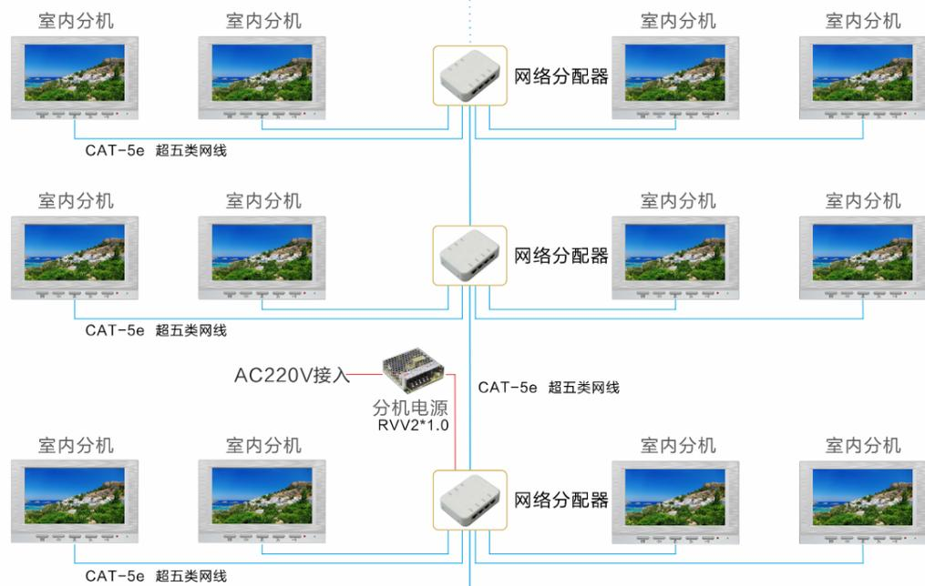
电源接法2: 1台分机电源给3-5台网络分配器供电。
